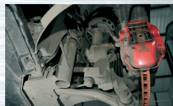
Na fot. zawieszenie wersji GT z „wysuniętą zwrotnicą”.
